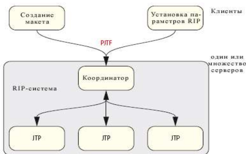
Рис. 4.14 Архитектура Extreme - RIPs
